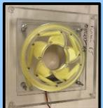
Le diaphragme permet d'être ouvert par le servo-moteur diffusant ainsi la lumière.
