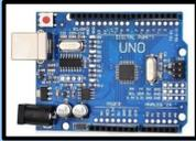
Carte Arduino Uno équipée d'un microcontrôleur. Elle assure la gestion de l'appareil.
