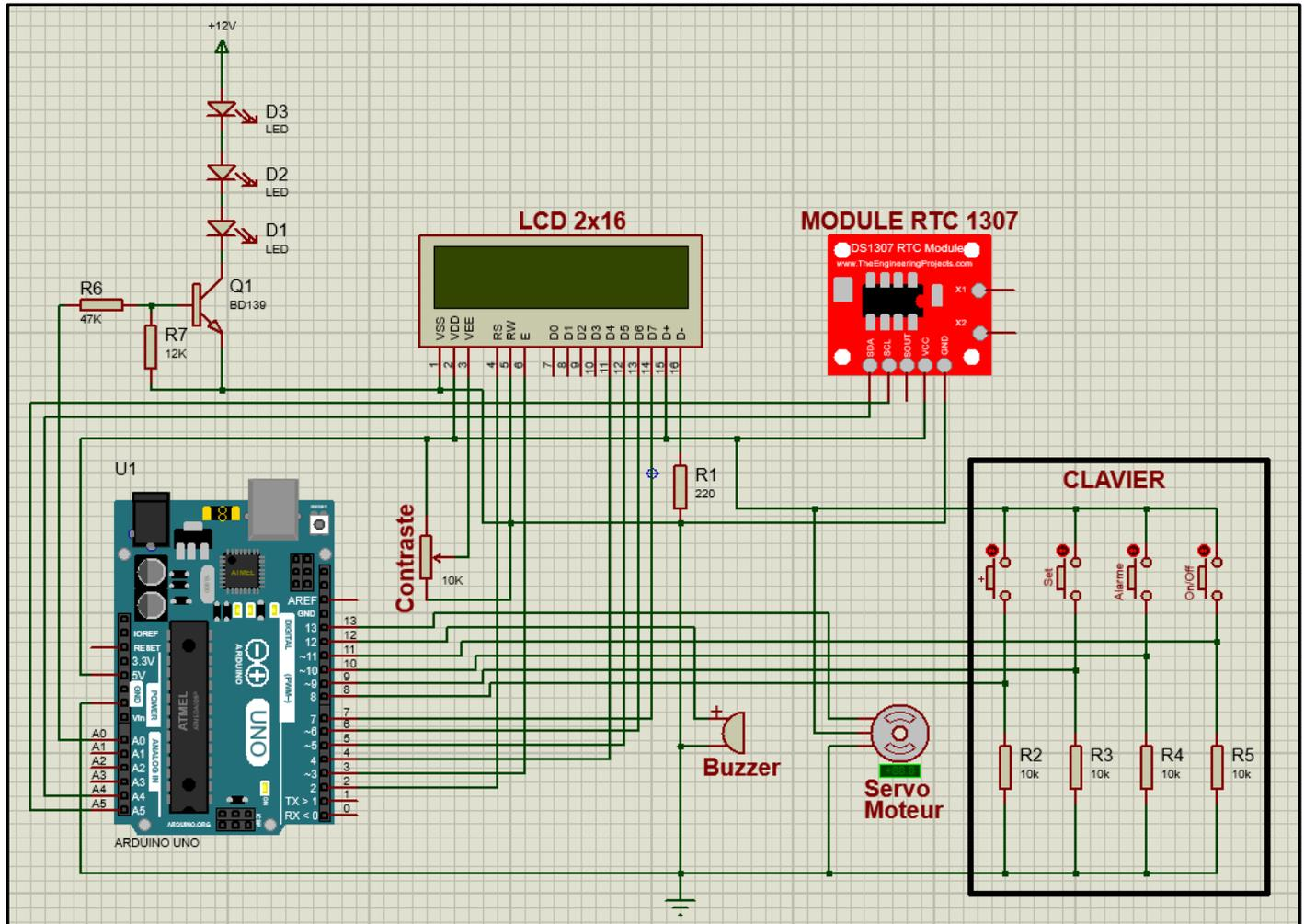
Dans un premier temps, seuls l'afficheur, les boutons poussoirs et le module RTC 1307 seront câblés. Le Buzzer et le servo-moteur seront connectés ultérieurement en raison d'un manque de place sur la plaque LAB.
