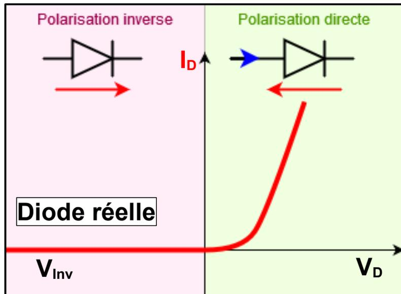
Dans la réalité, en polarisation directe, une tension minimum est nécessaire pour que la diode devienne passante. Elle est souvent négligée lorsque les tensions sont importantes :  $V_D = 0,7v$ . Les diodes ont un courant maximum à ne pas dépasser. Détériorée, elle devient souvent un court-circuit.
