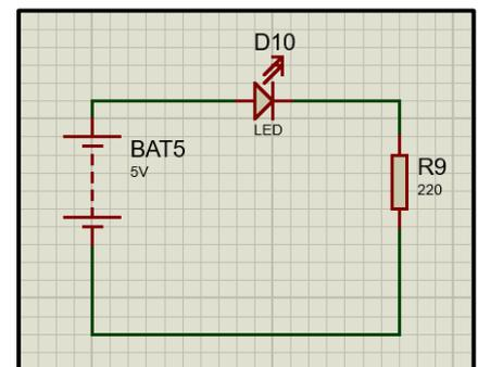
Point important à retenir : ne jamais brancher une LED à l'envers sous peine de la détruire car la tension inverse est relativement faible.
