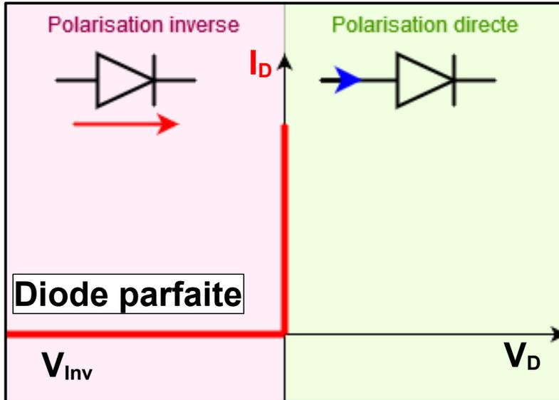
Pour simplifier l'étude des montages, la caractéristique utilisée est celle d'une diode idéale. (parfaite)
