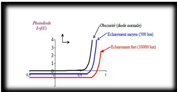
Caractéristique courant/tension d'une photodiode en fonction de l'éclairement. On constate que lorsque la diode est éclairée, elle peut se comporter en générateur ( $I = 0$ ,  $U = 0,7V$  pour 1000lux). On a donc affaire à une photopile (effet photovoltaïque).
