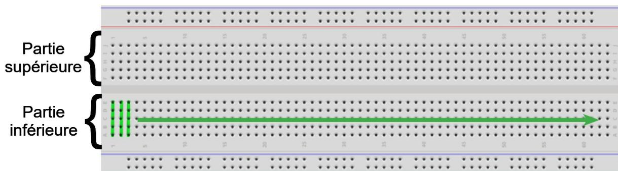
La flèche verte dans la partie inférieure montre que le principe de fonctionnement est le même sur toute la longueur de la plaque.
